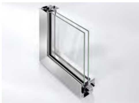
Schüco Fenster AWS 65 BC Fensterserie in Block Contour, konzipiert für den Wohn- und Objektbau mit einem U_f -Wert = 2,3\text{W}/(\text{m}^2\text{K}) bei einer Ansichtsbreite von 74 mm.
